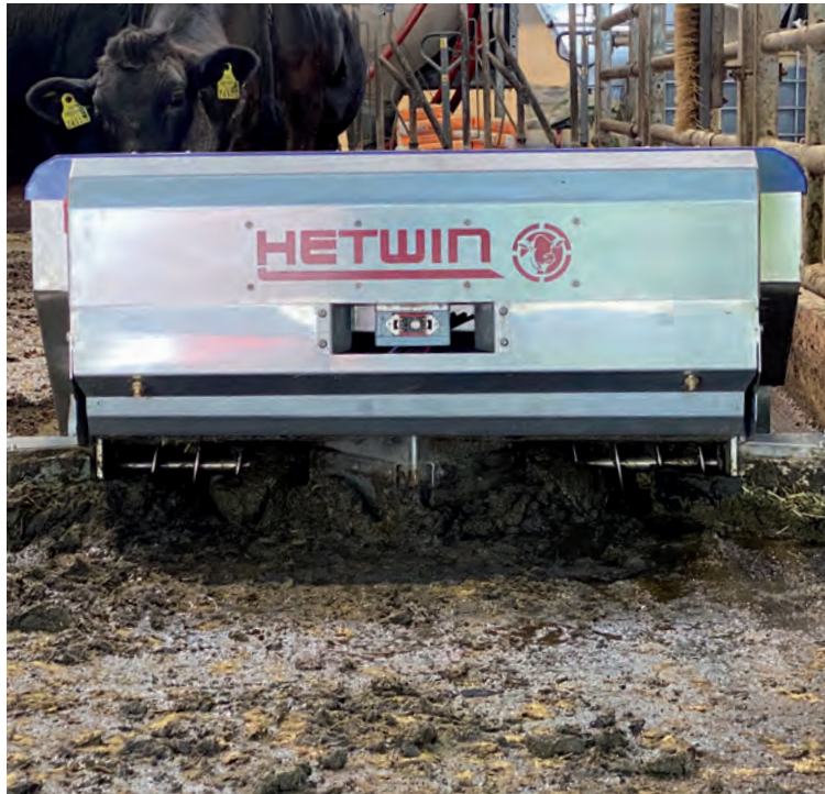
Prise en charge du fumier avec rotor à vis sans fin
