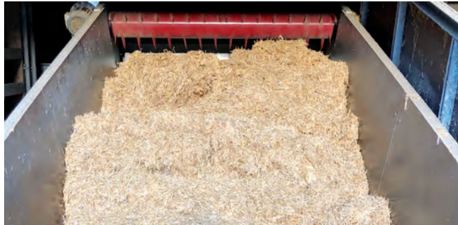
Classic 2DO Réservoir avec deux cylindres de dosage avec un fond mouvant pour petites et moyennes exploitations
