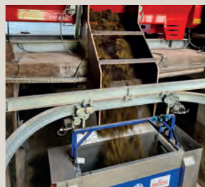
Pré-mélangeur avec grue et dosage d'aliments concentrés
